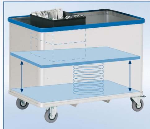
Prinzip-Darstellung des lastabhängig gefederten Bodens
