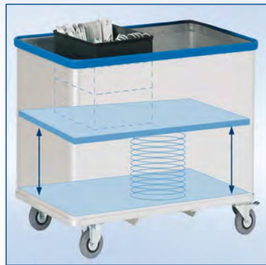
Prinzip-Darstellung des lastabhängig gefederten Bodens
